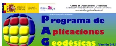
La calculadora geodésica del PAG permite realizar la transformación de puntos o ficheros entre ED50 y ETRS89, tanto en coordenadas geográficas como en UTM, así como obtener los valores de ondulación del geoide y desviación de la vertical.
