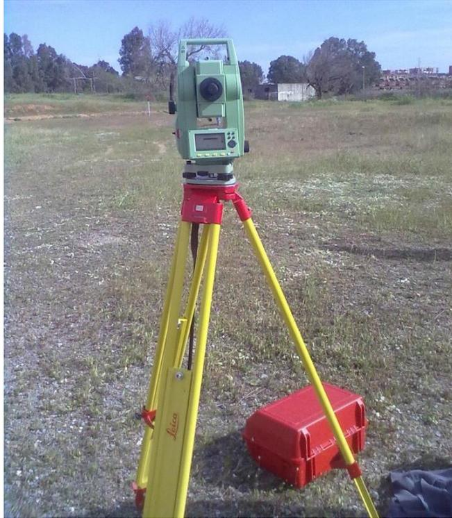
Figura 13: Estacion total Leica TC407 estacionada en un punto del terreno para la realización de la práctica 02.
