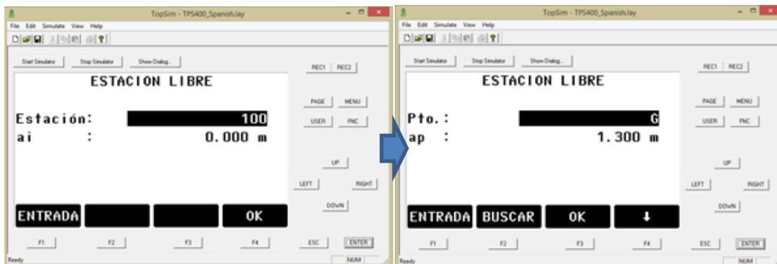
Figura 6: Inicio de medición de puntos en el programa *Estación Libre* del software TopSim.
