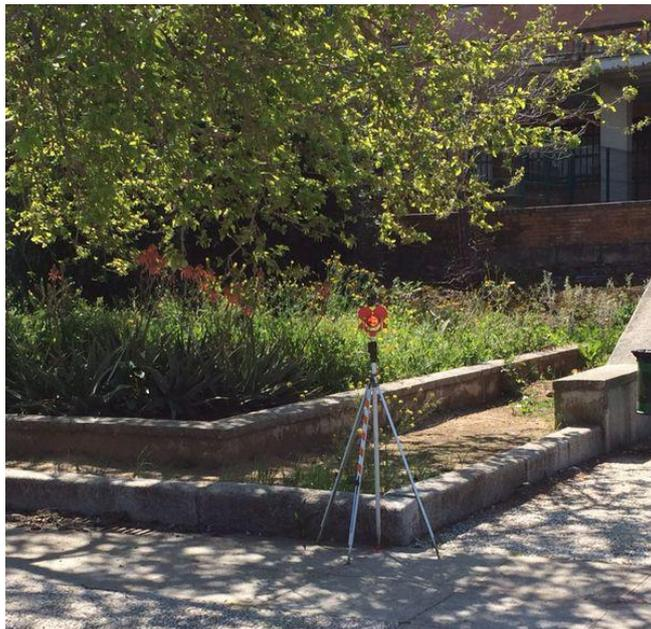
Figura 14: Prisma nivelado en una de las bases distribuidas por el campus de la ETSIA.
