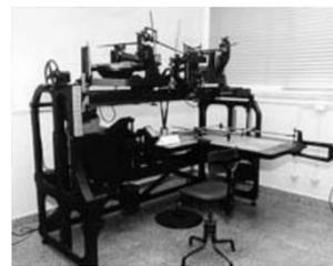
Por otro lado la confección de mapas, con información planialtimétrica, se realizaba con el principio de la marca flotante o con graficadoras basadas en este principio.
