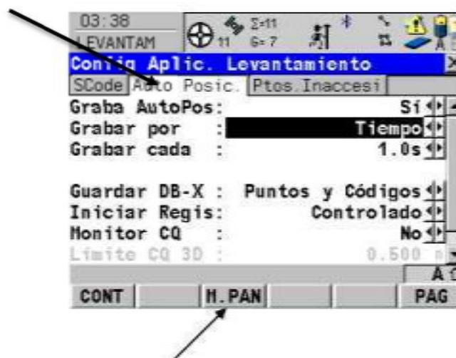
Imagen 25: Captura de pantalla del simulador GPS. (Fuente: Tema 9: Documento de Configuración inicial y creación de modos de trabajo en el simulador GPS\_GNSS 1200 de Leica).
